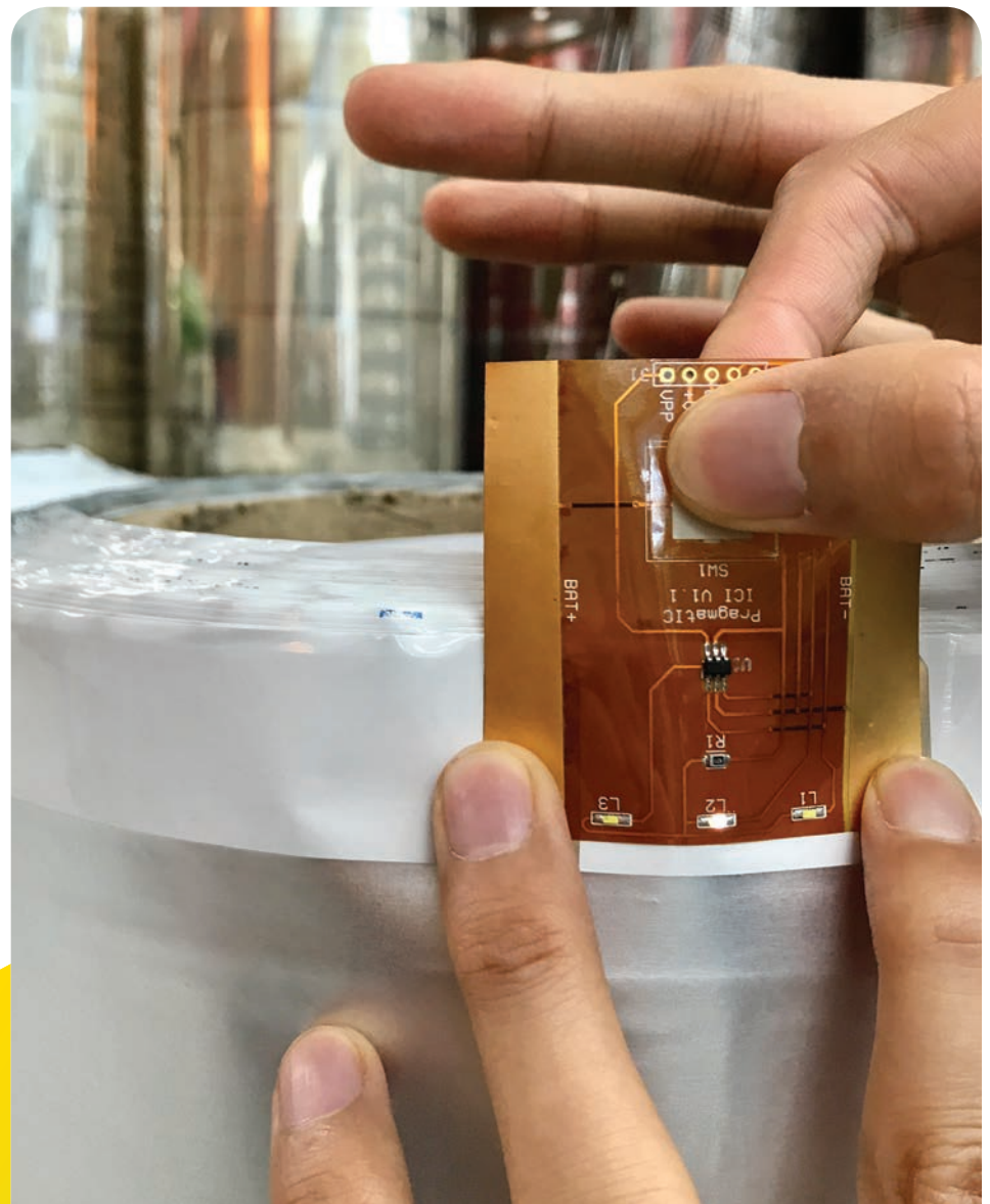
Cette année, nous avons réussi à imprimer de A à Z, sur la presse OMET de l'Institut, des rouleaux de batteries 3V flexibles et ultra fines. Chacune de ces batteries est capable de faire fonctionner un dispositif lumineux conçu pour des étiquettes intelligentes tel que montré sur la photo ! ».
